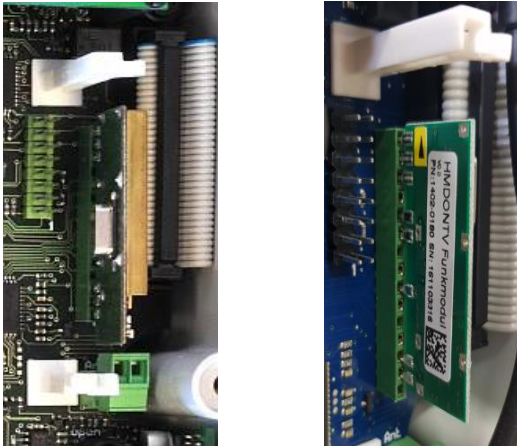
Afbeelding 15: Elektrische aansluiting radiografische ontvanger module
