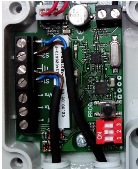
Afbeelding 17: Voorbeeld aansluiting veiligheidslijsten op de JCM-zender RB3R686
