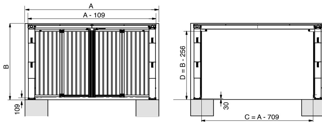
A = largeur d'ouverture ; B = hauteur d'ouverture ; C = largeur passage libre ; D = hauteur passage libre
